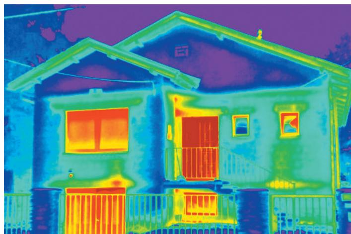
Ejemplo de construcción tratada con **PX-23 ISOLXTREM IMPER-SOUND** en la que puede observarse que los únicos puntos de pérdida de calor son las puertas y ventanas, quedando totalmente aislada térmica y acústicamente toda la superficie horizontal y vertical.
